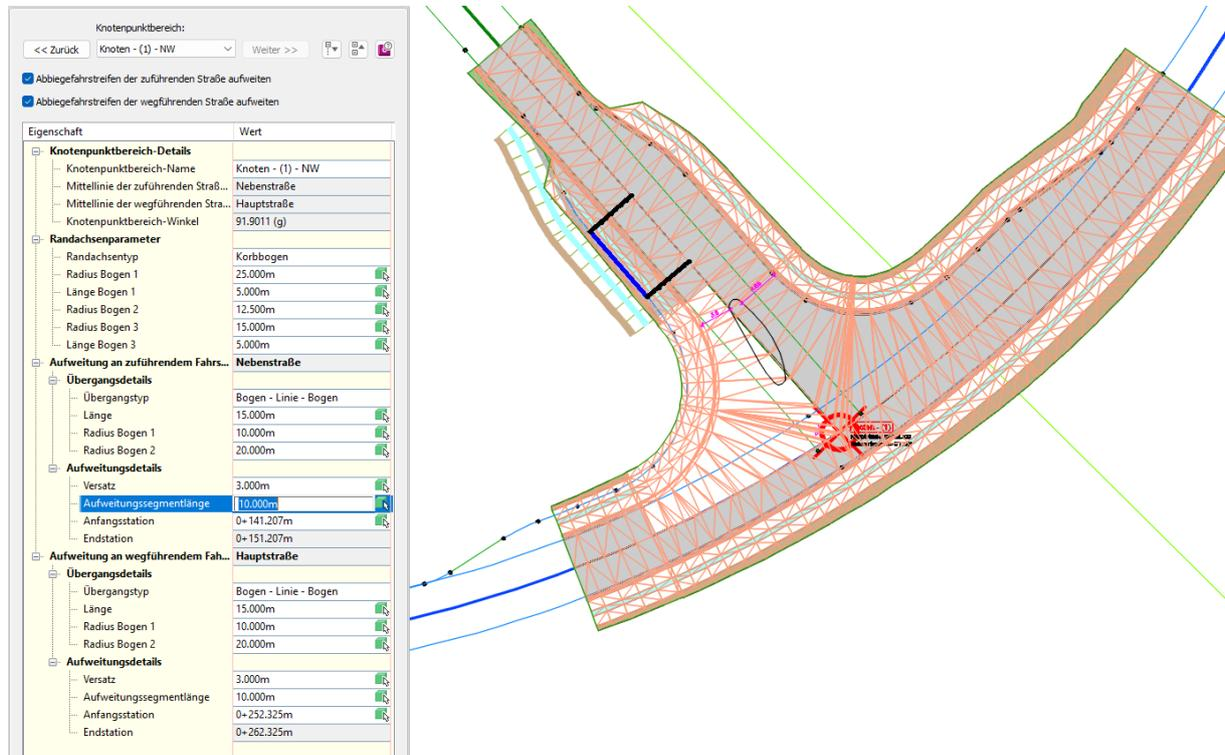
An das Editieren der verbundenen Achse im Lageplan sollte sich eine Kontrolle des konstruierten Längsschnittes im Höhenplan anschließen.
