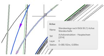
Die "Wendeschleife Lastzüge" hat eine Achse, die die Insel in der Mitte festlegt (Achse Breitensteuerung Mittelinsel).
