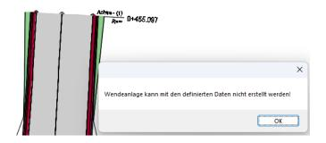
Die Funktion der Konstruktion von Wendeanlagen gelingt auch hier nur mit eigenen Querschnitten. Es werden mindesten drei eventuell vier Querschnitte benötigt.
