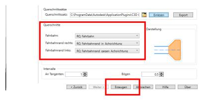
Es wird die Funktion "Erzeugen" gewählt. Die Funktion endet bei allen Wendeanlagen unter der Voraussetzung, Wahl der Funktion "Einlesen", mit der Meldung "Wendeanlage kann mit den definierten Daten nicht verstellt werden?
