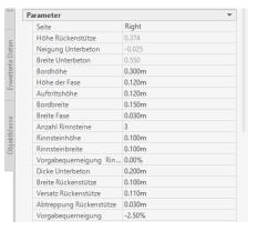
Das Böschungselemente kommt von der Karte "Basis". Für das Element "BöschungEinschnittGrabenBasis" werden die Voreinstellungen wie folgt geändert. Der Grund für die Änderung ist lediglich, die Größenordnung der erstellten Bestandteile (Böschung und Graben) sollen real erscheinen. Die Größenordnung ist im rechten Bild für die geänderten Werte wiedergegeben.
