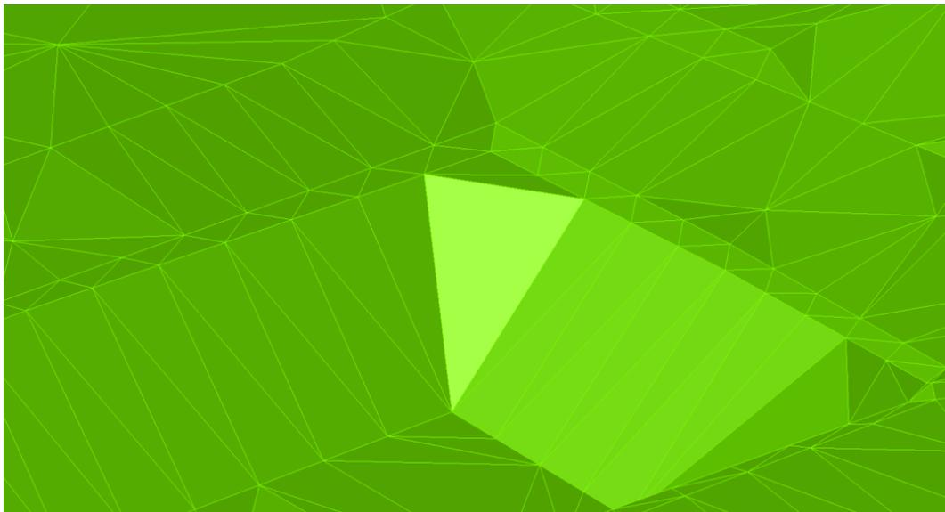
Unter „Bearbeitungen“ kann mit dem Befehl „Kante umdrehen“ eine Korrektur durchgeführt werden.
