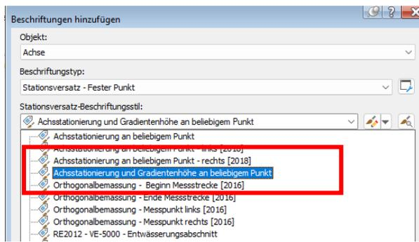
Die Beschriftung der Höhen zeigt, dass eine identische Höhe erreicht ist. Ist das nicht der Fall sollten weitere Höhenpläne erstellt sein und die dort dargestellten Gradienten bearbeitet werden.
