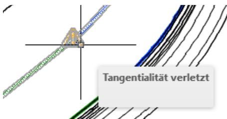
Alle Achsen mit diesem Hinweis können mit Hilfe des Achseditors nachbearbeitet sein, um sicher zu gehen das eine Straßenbau-Technisch richtige Konstruktion erfolgt.
